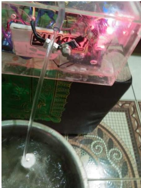
Gambar 7. Gambar Pengujian LED dan Pompa air menyala otomatis ketika suhu terdeteksi
