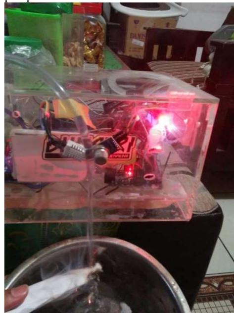
Gambar 9. Gambar Pengujian LED dan Pompa air menyala otomatis ketika asap terdeteksi
