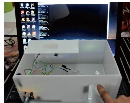
Gambar 11. Sensor magnetic door dengan kondisi terbuka
