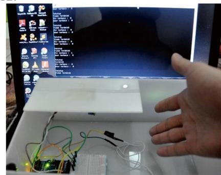
Gambar 12. Sensor PIR dengan mendeteksi pergerakan
