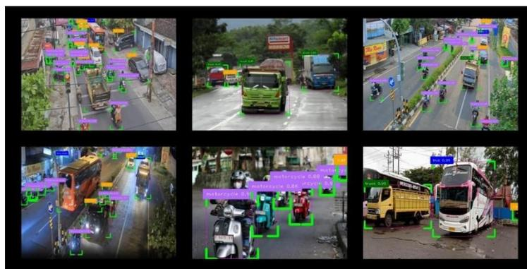
Gambar 10. Hasil Pendeteksian Kendaraan Dengan Model Latih
