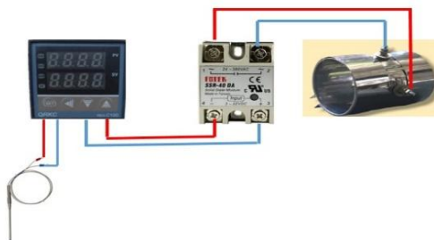
Gambar 6. Wiring heater dengan pengendali temperature
