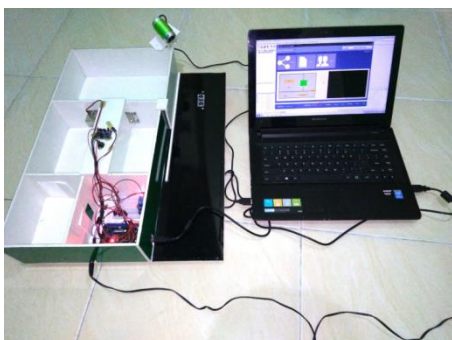
Gambar 5. Sambungan kabel USB printer ke DFRobot
